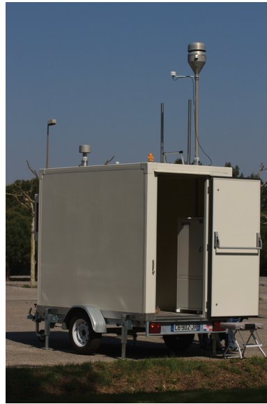
(b) Station mobile (remorque adaptée, Gensollen MGSA)
