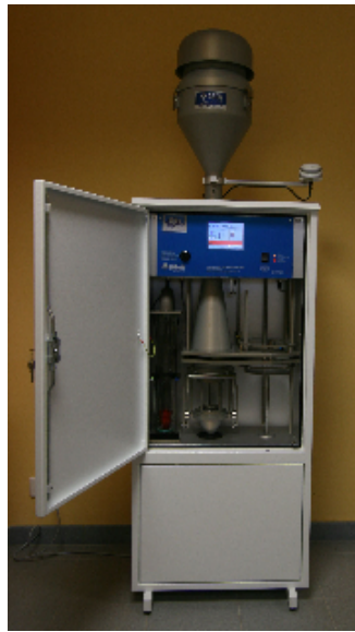
(a) Préleveur sur filtre à haut-débit équipé d'une tête de prélèvement PM_{2,5} (HVS DA-80, Digitel)
